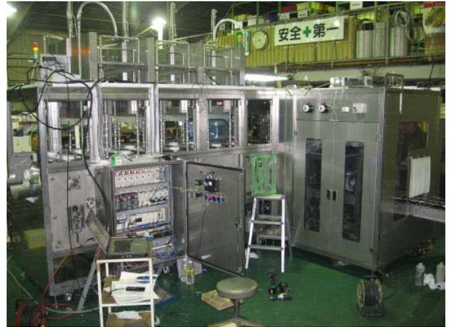
ウォーターサーバー用のガロンボトルを供給・充填・キャッピングまで行うミネラルウォーター用の充填ライン
