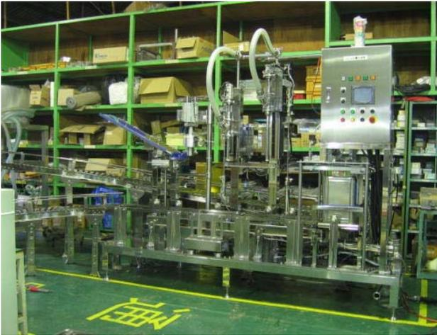
缶の供給から充填・キャッピングまで一連に行う一斗缶用の液体充填ライン
